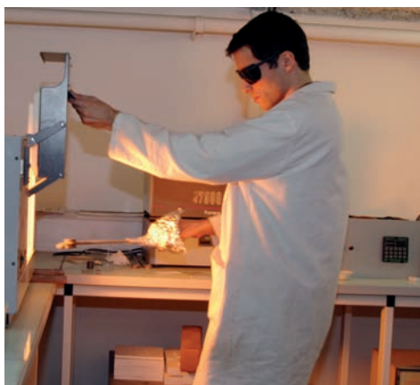
Utilisation d'un four pour la synthèse des verres à l'IMPMC- © P.Kitmacher. UPMC
