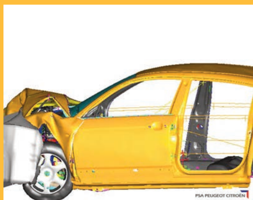
Simulation d'un essai de choc frontal d'une Citroën C6 Photos Patrick Legros
