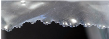
Feuille de plastique déchirée. Des fronces fractales apparaissent spontanément le long du bord créé par la déchirure. On peut expliquer le caractère fractal des motifs à partir de la théorie des plaques minces élastiques.
