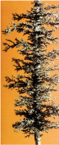
Dissolution chimique d'un bloc de plâtre obtenue après injection d'eau sous pression. G.Daccord et R.Lenormand
